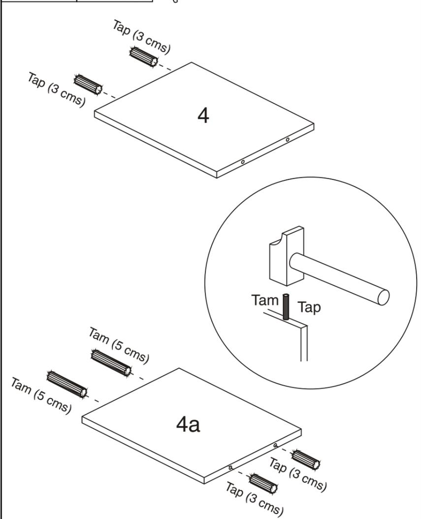
Los mechones "Tap" se utilizan para el ensamblado tanto del techo como del suelo
